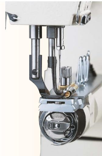
Horizontálně uložený velkoprůměrový chapač.
