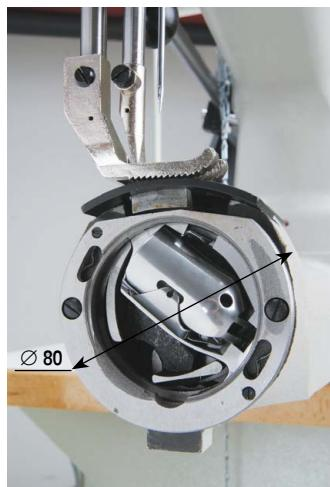
Barelový chapač zajišťuje dostačnou zásobu silných nití. Průměr ramene 80 mm umožnuje šití malých rádiusů.
