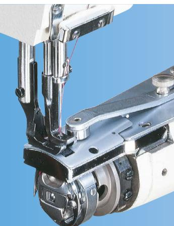
Stroje jsou vybaveny velkoprůměrovým horizontálně uloženým chapačem s cívkou o průměru 26 mm. Vodící pravítko s rolničkou lze doobjednat jako vybavení.
